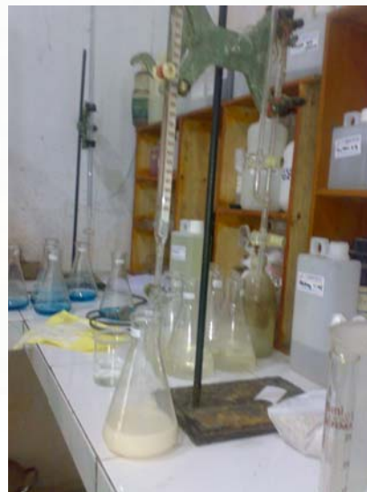
Gambar 7. Titrasi dengan Na-thiosulfat
