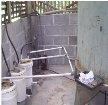
Gambar Penyaluran asap cair kepenampungan,
