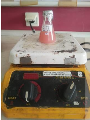
Proses koagulasi zat warna remazol red limbah cair batik dengan biji asam jawa
