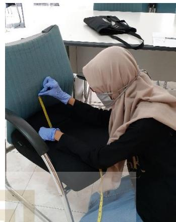
Gambar 12 Pengukuran Tinggi Lumbar
