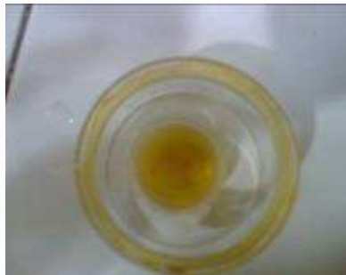
Gambar 5. Unit Micro conway Diffusion sebelum diinkubasi
