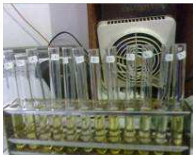
Gambar 7. Larutan \text{Cr}^{3+} sisa hasil reaksi yang telah diencerkan
