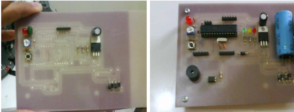
Gambar 3.4 Proses Pemasangan Komponen
