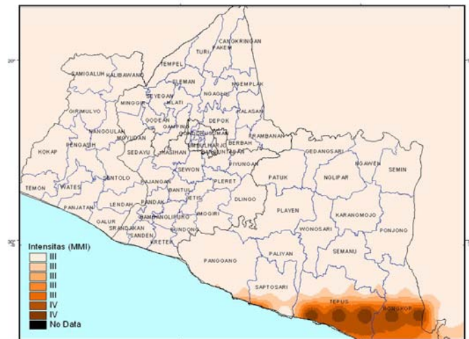
Gambar 4.9 Model intensitas validasi pada gempa bumi tanggal 19 November 2009 di wilayah DIY metode Mc.Guirre
