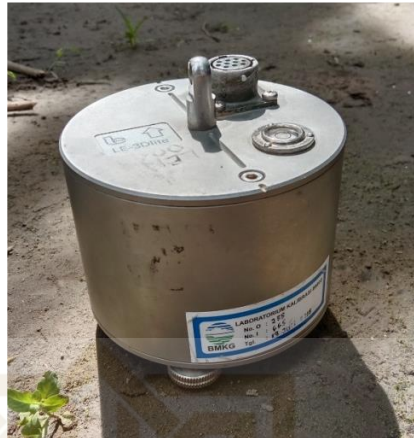
Gambar 3. 3 Seismometer tipe TDV-23S Taide
