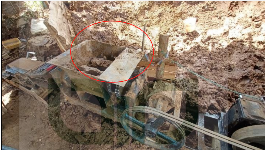
Gambar 1. 1. Mesin Penggilingan dan Pencetak Batu Bata Sumber: Analisis (2024)
