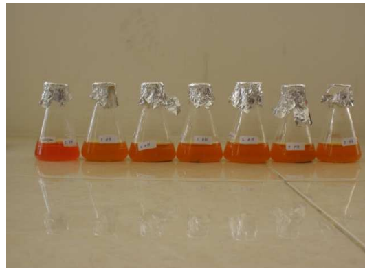
Gambar 4. Hasil adsorpsi zeolit terhadap methyl orange pada variasi pH
