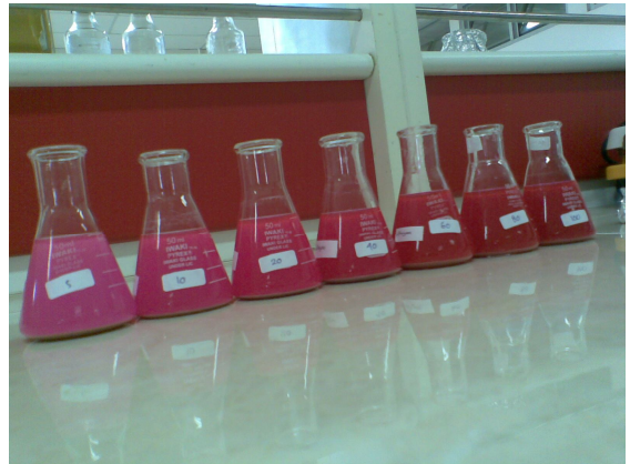
Gambar 4. Hasil adsorpsi zeolit terhadap rhodamin B pada variasi konsentrasi
