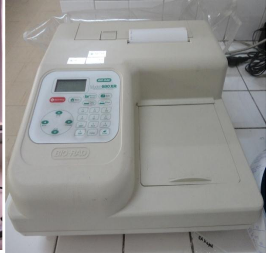
ELISA reader yang digunakan untuk mengukur absorbansi sel
