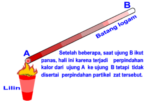
Gambar 4.12 Kalor mengalir pada logam yang dipanaskan (Sumber: pustakasekolah.com )
