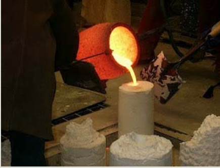
Gambar 4.5 Pengecoran logam dalam tempat pencetakan (Sumber: http://hmmftum.blogspot.com )
