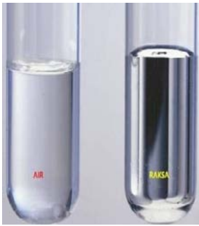
Gambar 2.19 Meniskus cekung dan cembung (Sumber: wawan fisika.files.wordpress.com)
