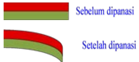
Gambar 3.10 Pemuaian pada bimetal (Sumber: http://fisikastudycenter.com )
