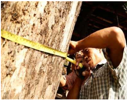
Gambar 1.2 Mengukur dengan meteran pita (Sumber: http://belajar.kemdiknas.go.id )
