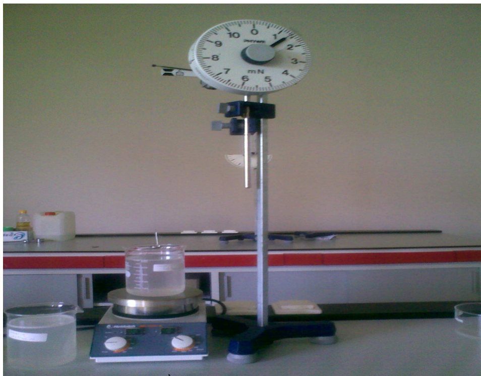
Gambar alat tensiometer du Noüy untuk penentuan tegangan permukaan
