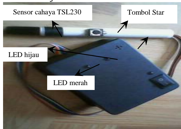
Gambar 4.1 Alat deteksi baksodaging sapi terkontaminasi boraks
