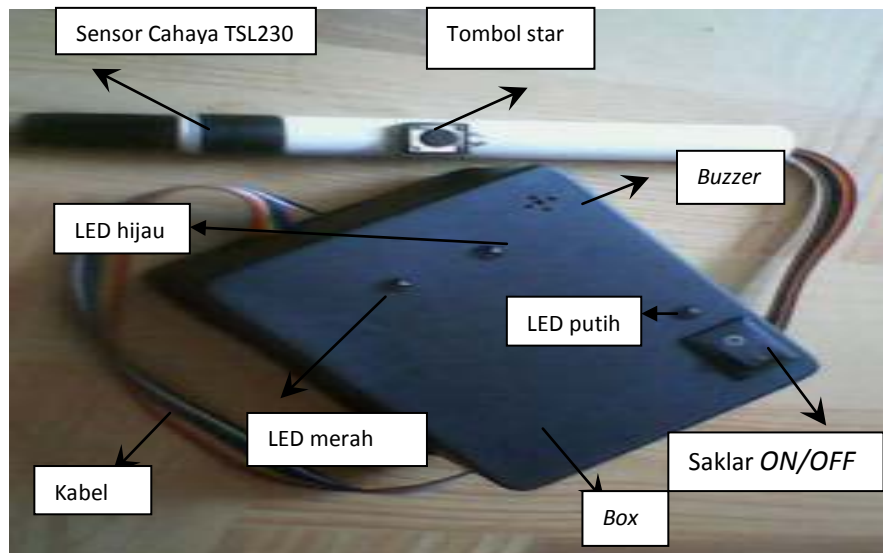
Gambar 4.1 Alat deteksi bakso daging sapi terkontaminasi boraks
