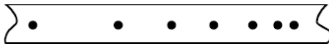
Gambar 1. contoh hasil percobaan untuk menyelidiki gerak lurus berubah beraturan diperlambat dengan jarak ketik yang semakin dekat
