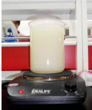
Gambar 1. pendidihan substrat menggunakan Hotplate
