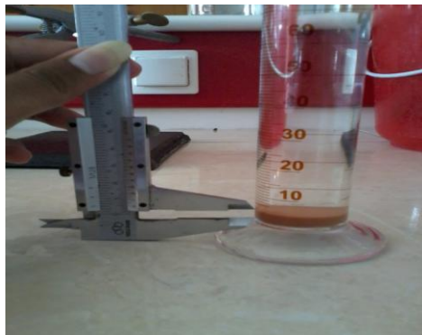
Gambar. Uji Daya Mengembang Bentonit
