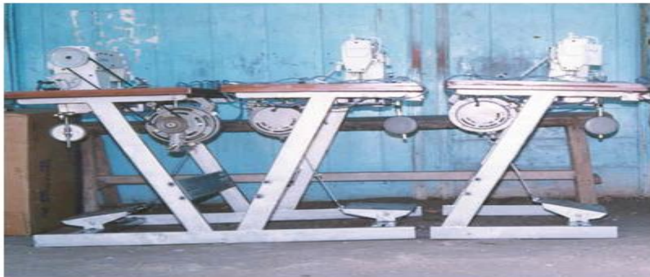
Mesin Jahit High Speed setelah melalui tahap rekondisi
